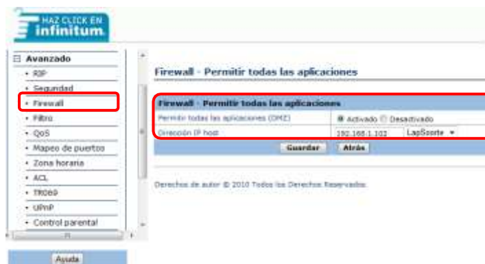
Figura 20. Ingresando IP local en DMZ.
