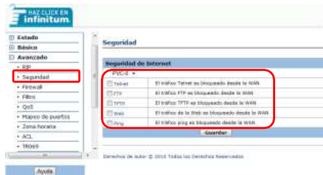
Figura 18. Validando las opciones de seguridad en el MODEM.
