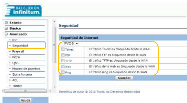
Figura 4.1-1. Validando las opciones de seguridad en el MODEM.
