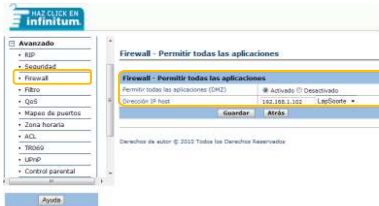
Figura 4.1-3 Ingresando IP local en DMZ.
